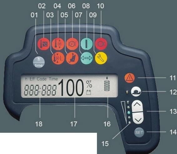
01. Переключатель счетчика моточасов/часов
